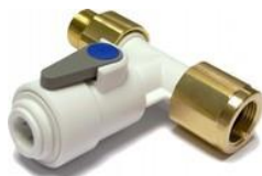
Anschluss für Eingangswasser (Zulauf) mit integriertem Rückschlagventil John Guest 2 x 3/8" Ø 3/8"
